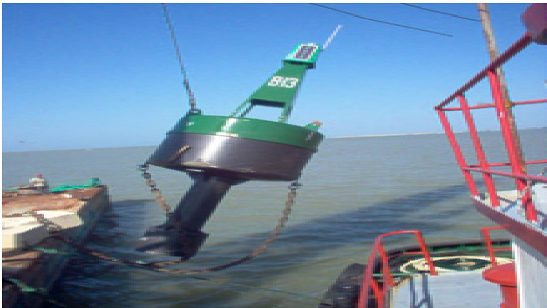
Modelo de boyas que indican a los navegantes el canal de navegación en la barra (Fuente: Construcciones Taromar.C.A.)
