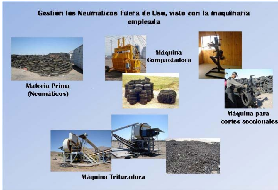
Figura 1. Gestión de NFU vista con la maquinaria empleada
