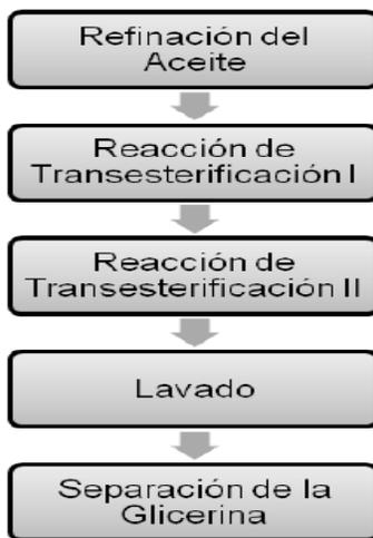
Figura 1. Proceso de producción del biodiesel
