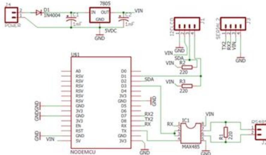
Figura 6. Diagrama esquemático de la unidad maestra
