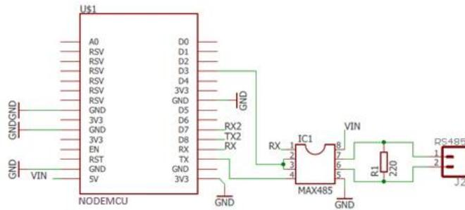
**Figura 8. Diagrama de conexión nodeMCU con convertidor max485.**
