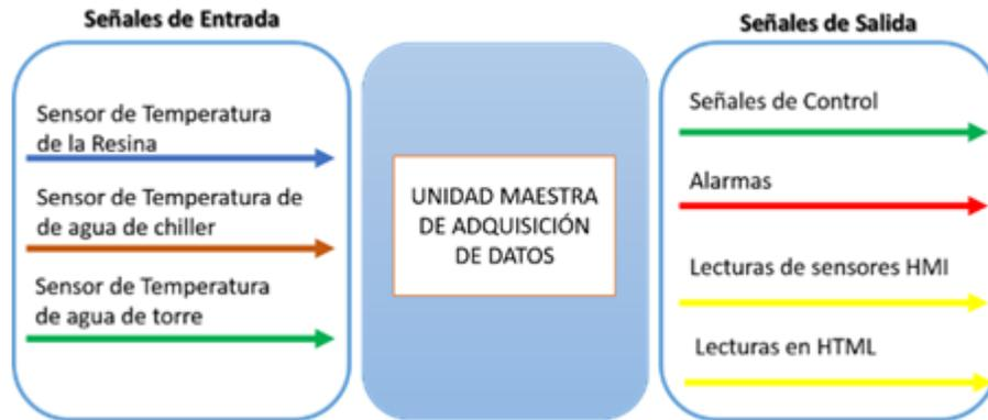
**Figura 3. Diagrama de entradas y salidas**
