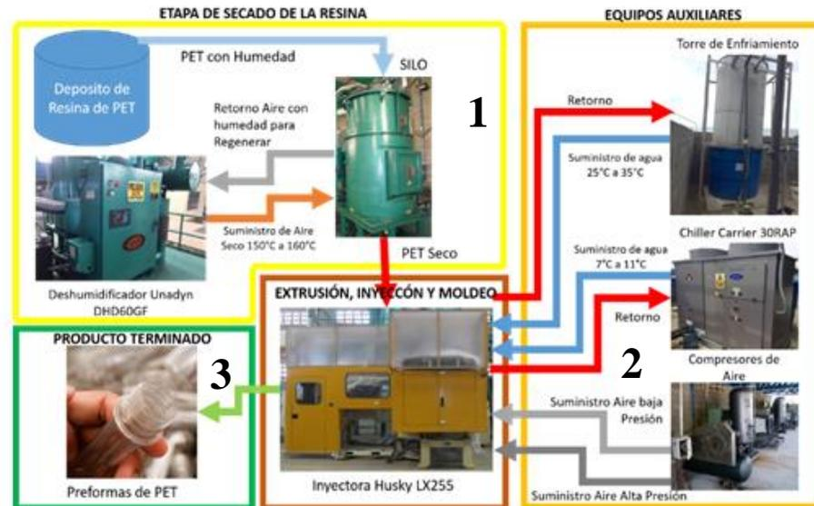
Figura 1. Equipos que intervienen en el sistema de inyección de preformas
