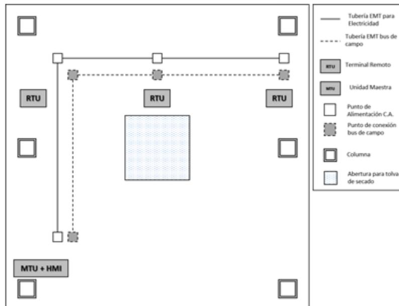
**Figura 2. Diagrama de canalización de tuberías**
