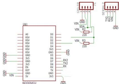
**Figura 9. Pines de conexión I<sup>2</sup>C y Serial TTL.**
