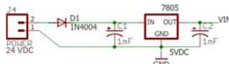
Figura 7. Diagrama de alimentación eléctrica.
