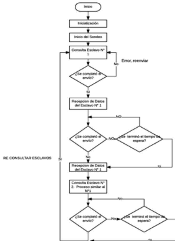
Figura 5. Diagrama de flujo de comunicación de unidad maestra modbus
